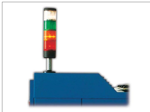
Le principali condizioni di stato del sistema sono segnalate all'operatore da una "torretta luminosa" a quattro colori.
